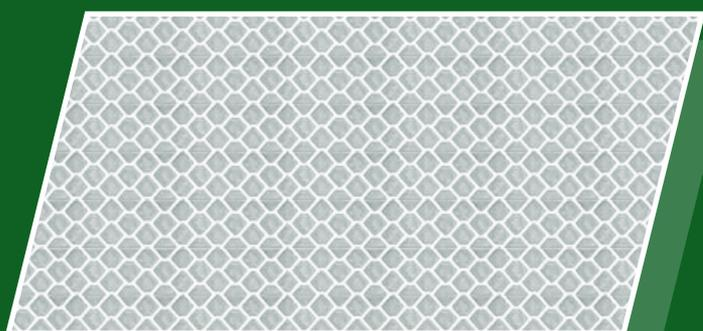
Technologie microprismatique de type classe 3 (nid d'abeille). Les microprismes sont formés dans une résine transparente synthétique, puis scellés sur le film support enduit d'un adhésif permanent sensible à la pression et protégé par un film protecteur polyéthylène.
